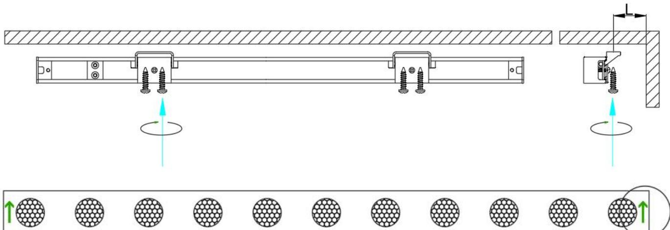
注意灯具安装方向，箭头指向靠墙端
